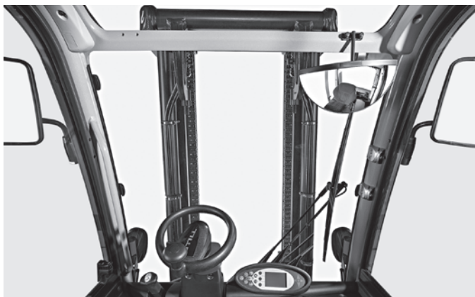
Узкие профили мачты обеспечивают хороший обзор вил и перевозимого груза в любое время
