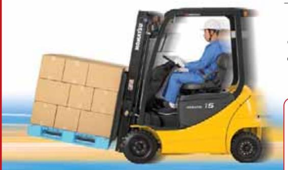
Полноповоротный двойной привод, при котором каждое из двух передних колес приводится во вращение своим электродвигателем переменного тока, обеспечивает ходовые качества, сопоставимые с таковыми у погрузчиков с ДВС. Полноповоротный двойной привод Komatsu действительно обеспечивает прекрасные ходовые качества даже на самой неподходящей поверхности пола или грунта.
