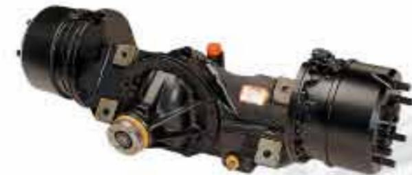
Шплинтованные соединения шестерней позволяют передавать большой вращающий момент на ведущие колёса.
